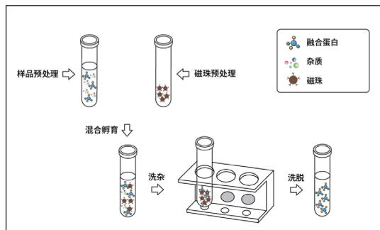
图1. Magneti-G Anti-His Beads使用流程图
