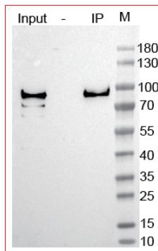
图2.通过Magneti-G Anti-His Beads进行IP后的WB图
